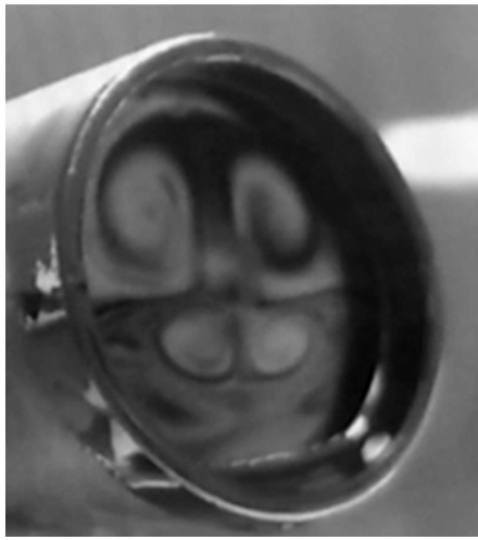
Figure 7 Photographie de la figure d'interférence (à gauche) et représentation schématisée associée du mouvement du cylindre (grisé) et des tourbillons générés (à droite)
