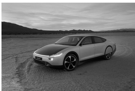
Figure 10 La société néerlandaise Lightyear propose une berline équipée de 5 \text{ m}^2 de panneaux solaires qui mesure 5,05 m de longueur, 1,82 m de largeur et 1,40 m de hauteur et possède un coefficient de traînée C_x = 0,23
